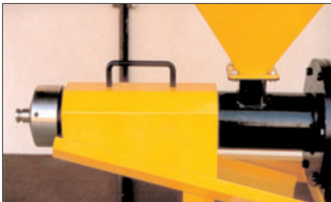
Nad stiskalno glavo je nameščen ščitnik, ki preprečuje pršenje olja.
