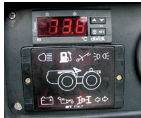
Pogled na elektronski termometer na armaturni plošči, kjer nastavimo najvišjo temperaturo segrevanja olja
