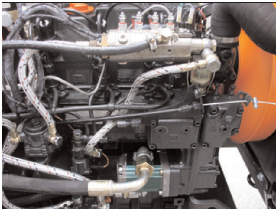
Električna grelna enota za zmanjševanje viskoznosti rastlinskega olja (Hocem Logatec) na traktorju AGT 835 (Agromehanika Kranj)
