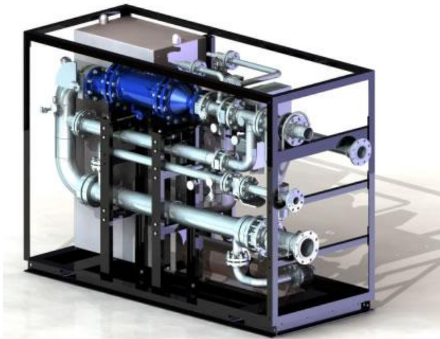
Slika 10: Primer nizko-temperaturnega organskega rankinovega cikla (ORC)
