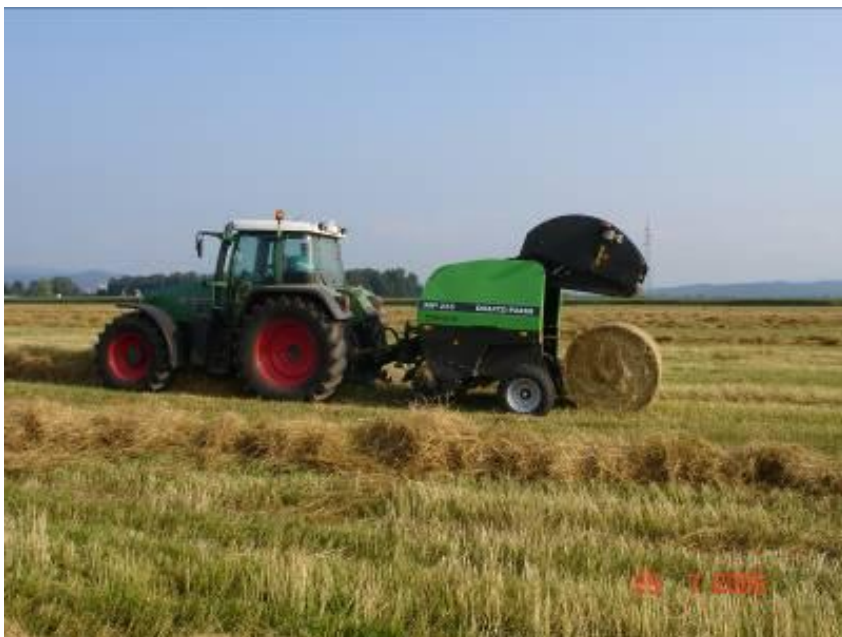
Slika 1. Za pobiranje slame in koruznice in stiskanje oziroma izdelavo suhih bal za zmanjševanje prostornine žetvenih ostankov za energetske namene se lahko uporabljajo obstoječe stiskalnice za valjaste bale, ki so razširjene v slovenskem kmetijskem prostoru
