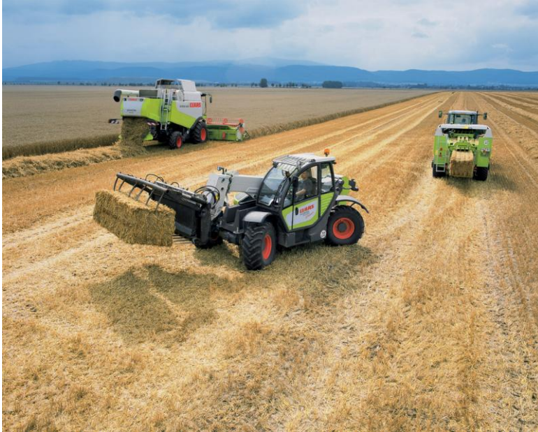
Slika 8. Linija za spravilo velikih kvadrastih bal, žetvene ostanke, ki nastanejo po spravilu žita s kombajnom pobere stiskalnica za velike kvadraste bale, za nakladanje bal je namenjen dvoriščni traktor s teleskopsko nakladalno roko, kvadraste bale se nakladajo na posebne izvedbe prikolic za prevoz kvadrastih bal (Class)
