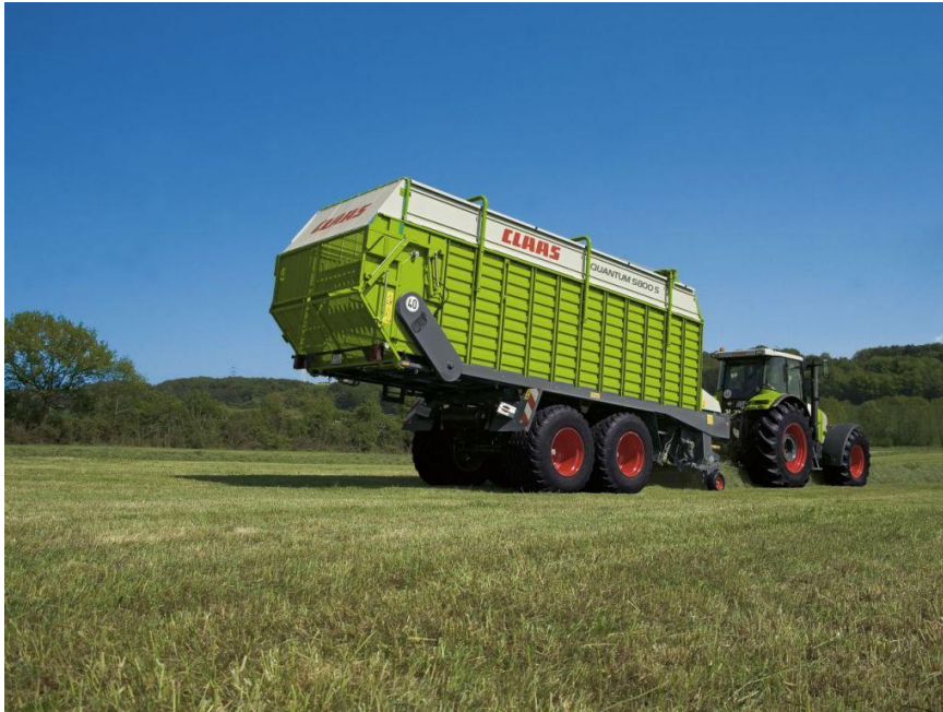
Slika 4. Samonakladalna prikolica prostornine 40 m 3 , potrebna moč traktorja 130 kW (Claas).
